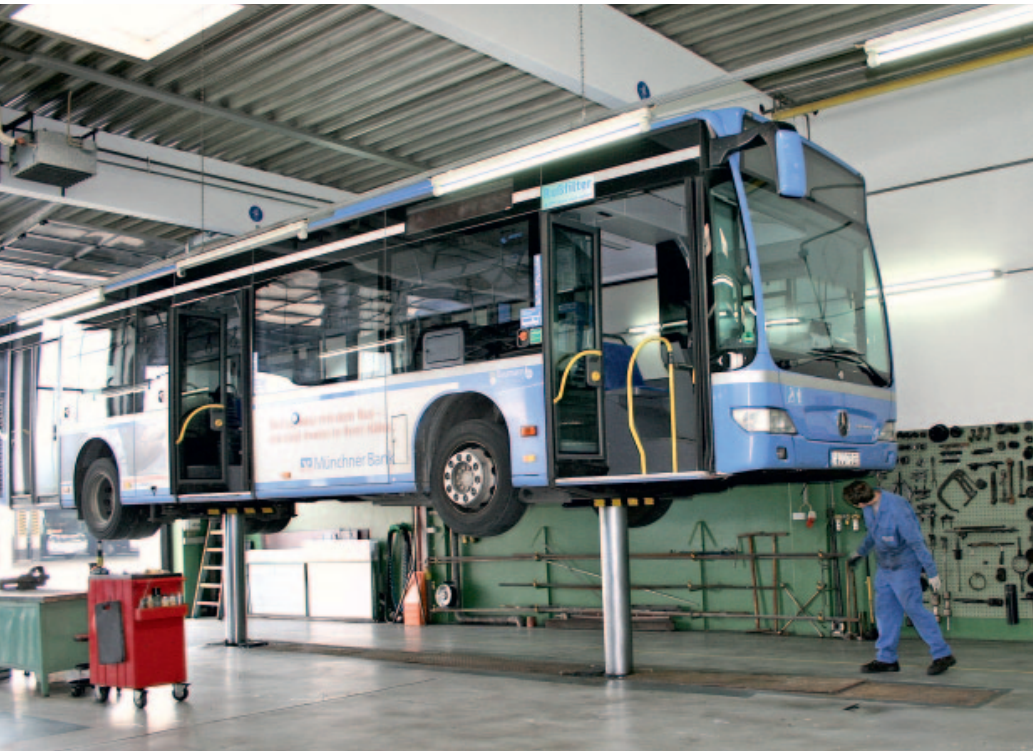
Auch eine Zwei-Stempel-Hebebühne gehört zur Werkstattausrüstung
